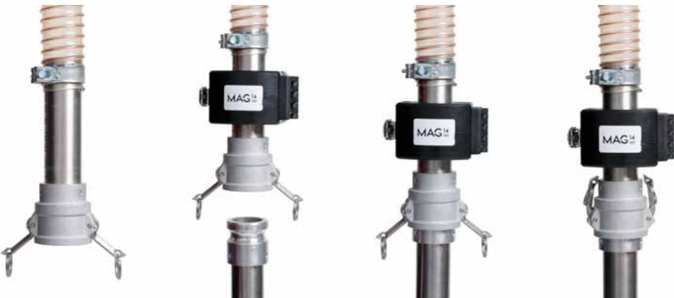
Der Förderschlauch im vertikalen Verlauf bietet die ideale Einbausituation und gleichzeitig eine einfache Abkoppelstelle sowie Auswurfmöglichkeit der ferritischen Rückstände.
