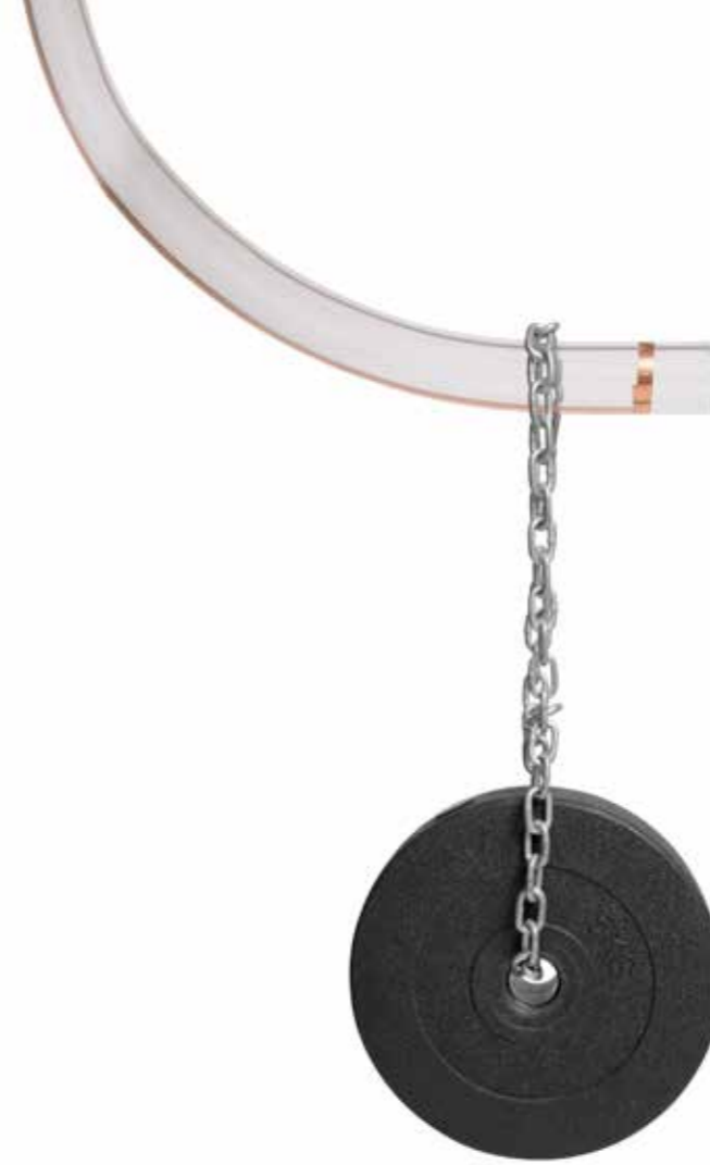
Glasrohrbogen R500 (47,0x5,0mm) mit 5kg Gewicht (statische Belastung)
