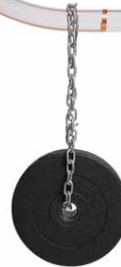
Glasrohrbogen R500 (47,0x5,0mm) mit 5kg Gewicht (statische Belastung)
